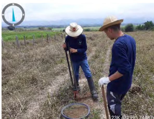
Figuras 4.20 e 4.21: Abertura do poço-teste com auxílio de cavadeira manual tipo boca de lobo (PT's 012 e 067, respectivamente).
