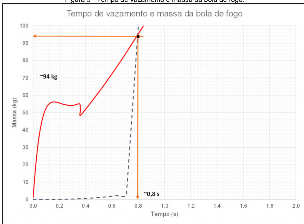
Figura 9 - Tempo de vazamento e massa da bola de fogo.
